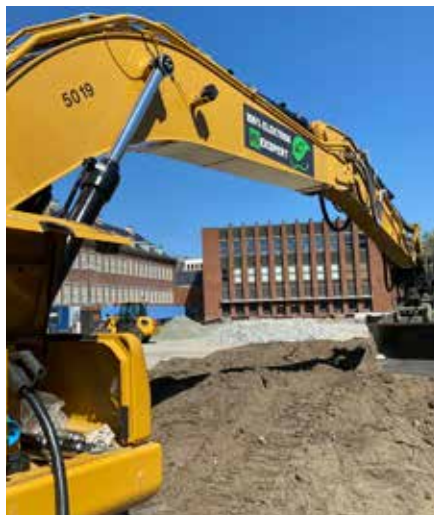
Ladepause: CAT 320'en tar en ladepause. Påfyllet er 150 KW. Maskinen hurtiglades i lunsjen, mens nattestid lades den med AC.
