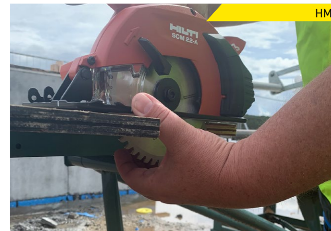
Et lite sekund uten fokus. På refleks tok Tarjei tak i den overskytende biten, uten å tenke på sagbladet i underkant av plata. (Rekonstruksjon)
