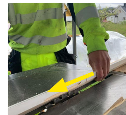
Jan skulle splitte en list ved hjelp av en spaltekniv og gjerdesag - som så ofte før. Denne gangen fikk det alvorlige følger. (Rekonstruksjon)
