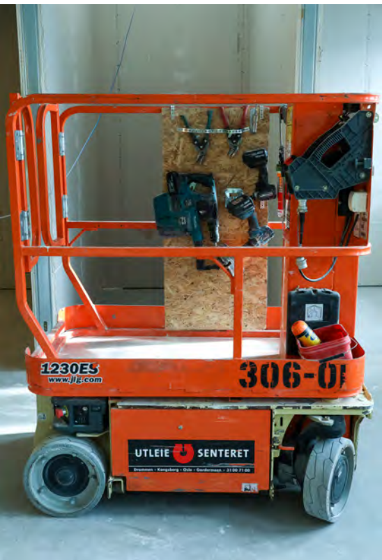
På prosjekt Tine har en av underentreprenørene laget en innretning for å henge opp verktøyet han har med i liften. Dette reduserer risikoen for snubling, og å sparke verktøyet ned på noen som oppholder seg under liften.
